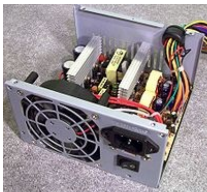
Intérieur d'un bloc d'alimentation
