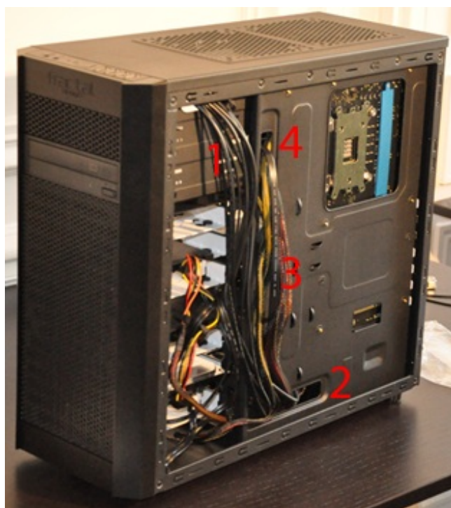
Passage des câbles derrière la plaque de la carte mère
