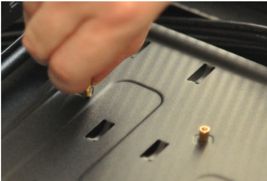
Mise en place des entretoises
